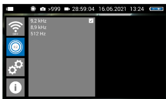
Bild 33: Lokaliserings-sändare med 9,2 kHz sändningsfrekvens vald
